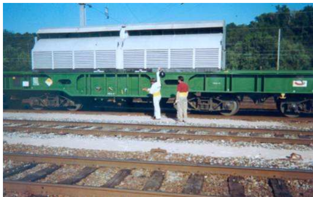
Mesure du rayonnement d'un convoi de combustible irradié (sud de Lyon, laboratoire CRIIRAD, B. Chareyron, 1998)
